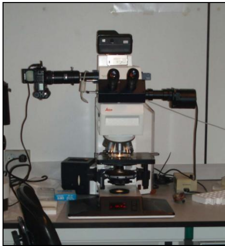
Figura 20: Microscopio con cámara utilizado para contabilizar las células de diatomeas.
