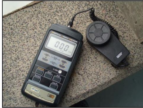
Figura 17: Luxómetro para medir diariamente la intensidad de luz a la cual estaban sometidos los cultivos de diatomeas.
