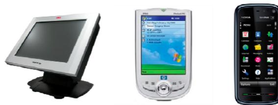
Figura 2.18: Pantallas resistivas en TPV, PDA y Terminal Móvil.
