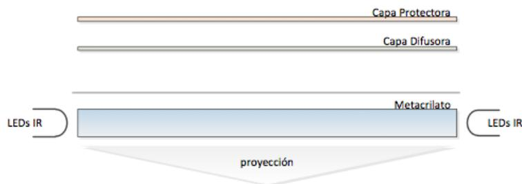
Figura 5.7: Capas de la superficie del prototipo.
