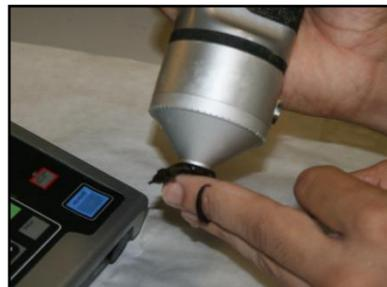
**Figura 14.** Medición del color mediante un colorímetro (Minolta Chroma Meter CR-200, Minolta, Osaka, Japan)
