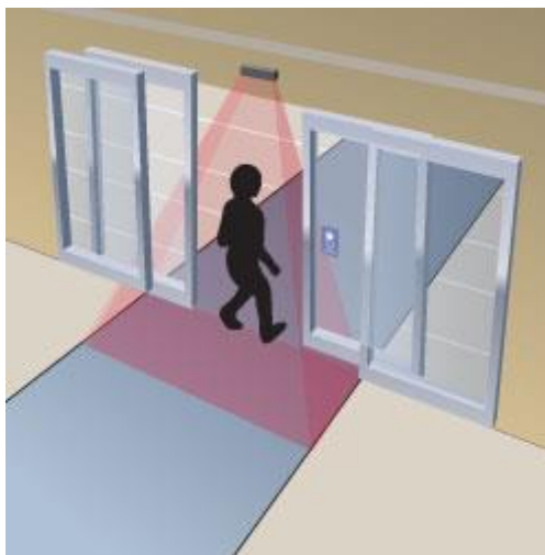
Figura 7: Instalación típica de un sensor de movimiento
