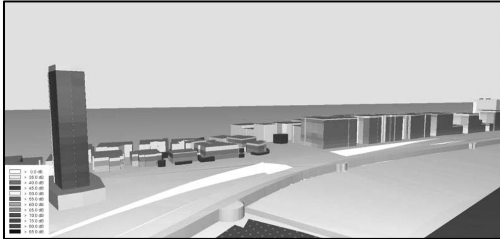
Figura I.6.34. Mapa de niveles acústicos mínimos recibidos en fachada de edificios de la zona de Alcaravaneras durante el periodo de noche para el caso a.
