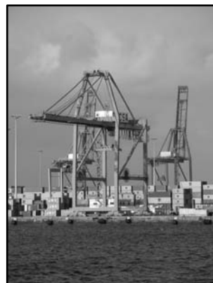
Figura I.5.70. Grúas de carga-descarga de contenedores.
