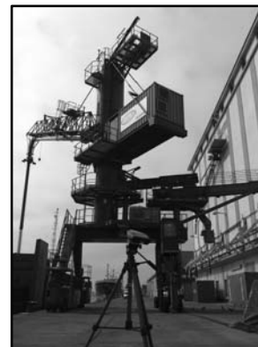
Figura I.5.60. Descarga de cebada barco-silo con pórtico de descarga.
