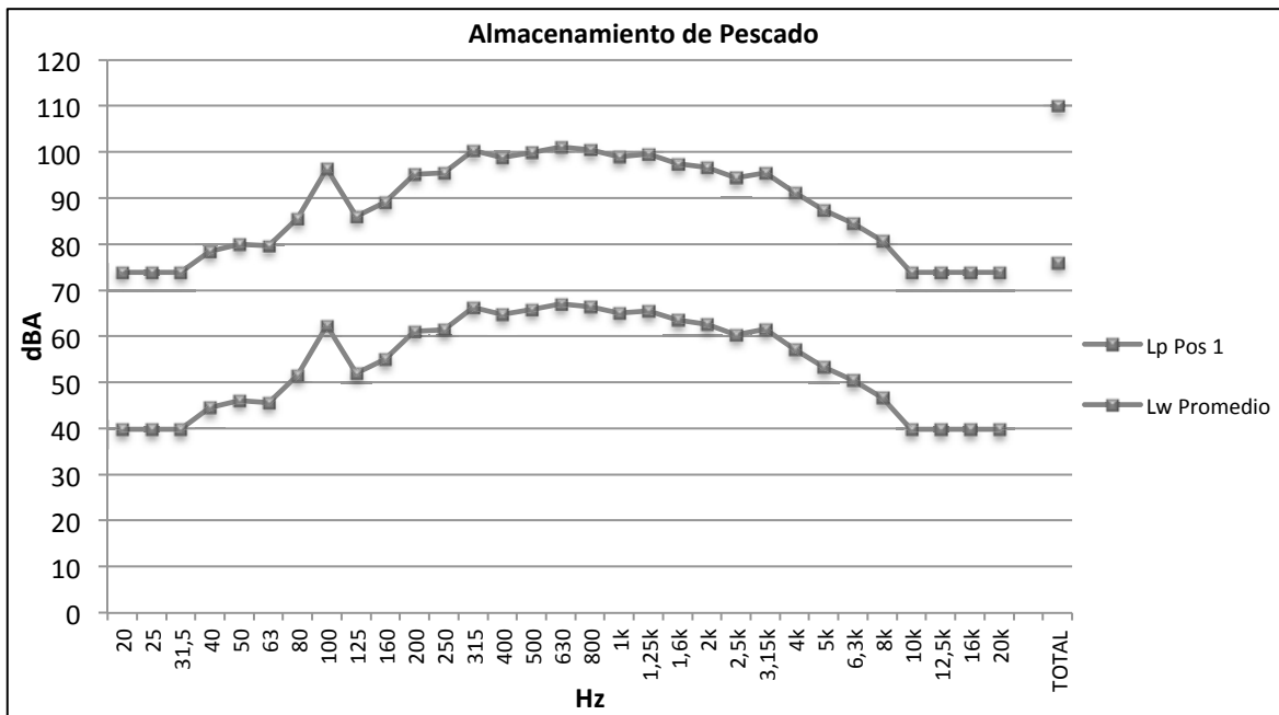
Gráfico I.5.106. Espectros de presión sonora y potencia acústica en tercios de octava.
