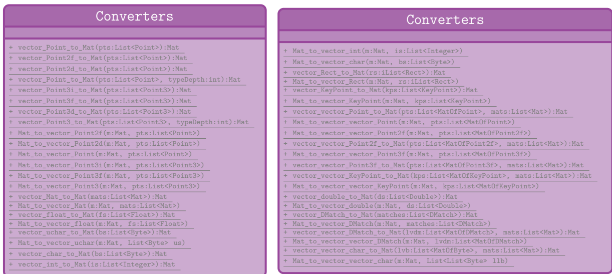
Figura 3.42.: Representación UML de la clase Converters .
