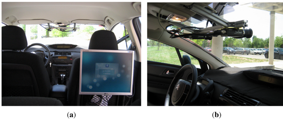
Figura 2.1.: Sistema de reconocimiento en tiempo real típico. a) Ordenador. b) Cámara.
