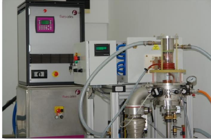
**Figura 33. Horno empleado en la síntesis de las aleaciones.**
