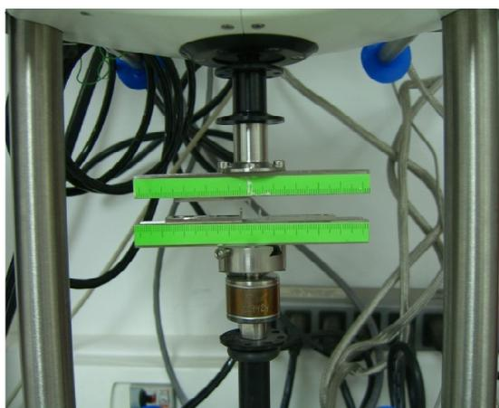
Figura 64. Detalle del accesorio para las pruebas de flexión.
