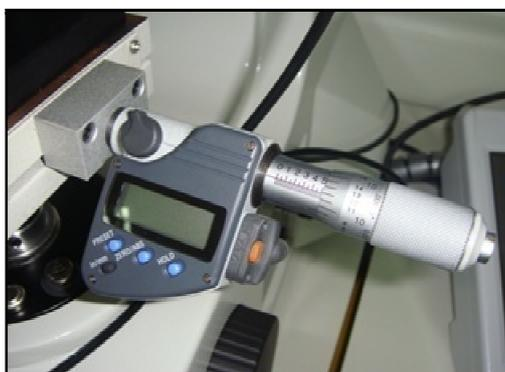
Figura 54. Detalle del microdurómetro.
