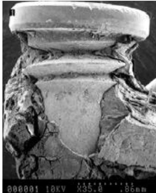
**Figura 25. Microfotografía realizada con microscopio electrónico de barrido de mini implantes retirados del fémur de una rata.**
