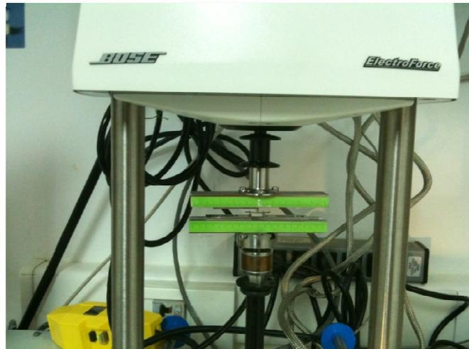
Figura 72. Ensayo de flexión en la BOSE Electroforce
