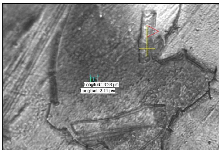
**Figura 193. Ti15Ta 1g ensayo n°: 4 176,4HV.**
