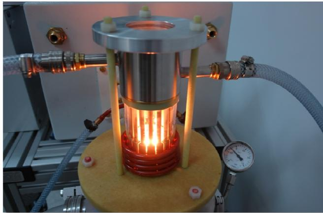
Figura 35. Fusión de la aleación de TiTa.
