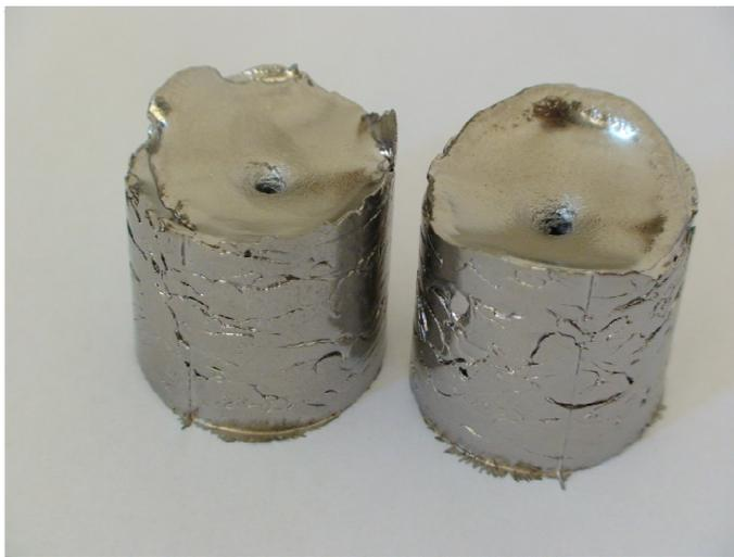
Figura 37. Lingotes de TiTa obtenidos con diámetro de 30mm.
