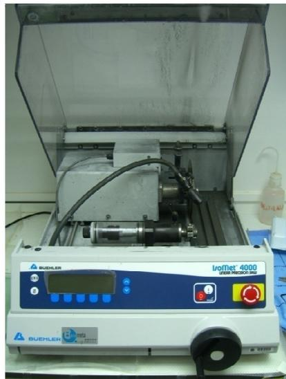
Figura 61. Sierra de lineal de precisión.
