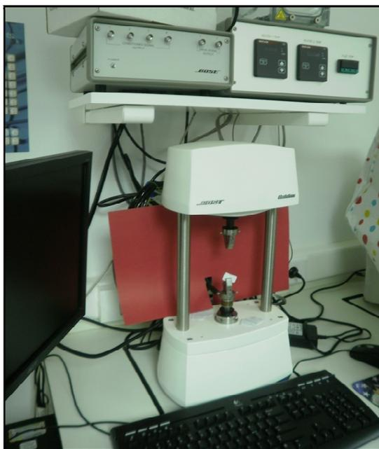
Figura 63. Máquina de ensayos BOSE Electroforce.
