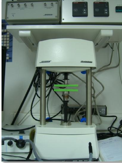
Figura 206. Máquina de ensayos BOSE Electroforce.
