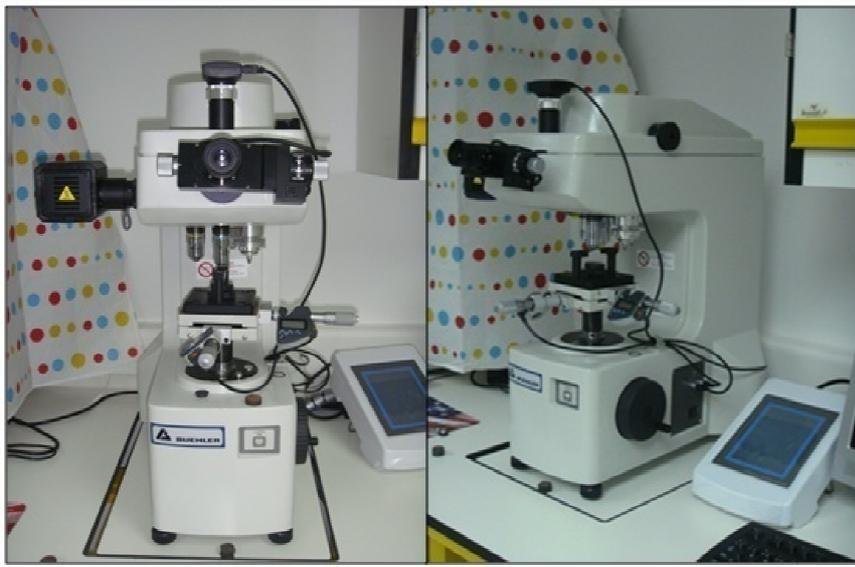
Figura 53. Microdurómetro empleado.
