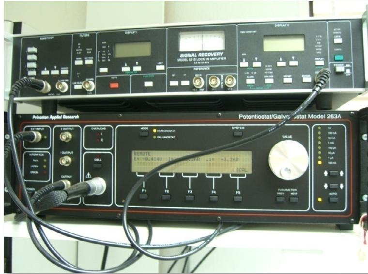
Figura 56. Potenciostato/Galvanostato.
