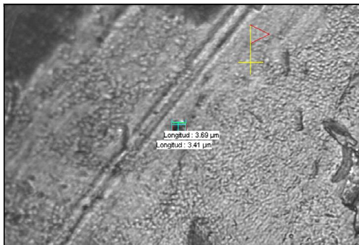
**Figura 192. Ti15Ta 1g ensayo n°: 3 151,5HV.**
