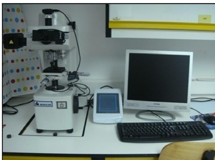
Figura 55. PC conectado al microdurómetro.
