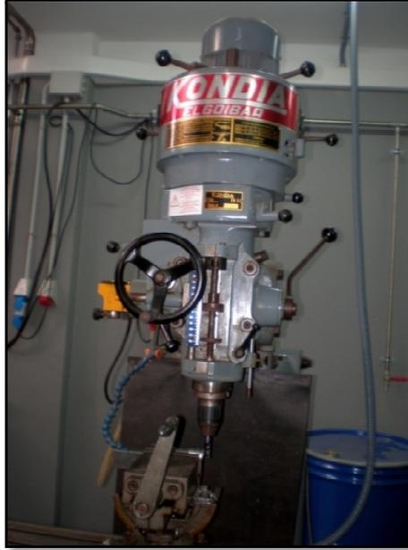
Figura 46. Fresadora Kondia Elgoibar modelo FV-1.
