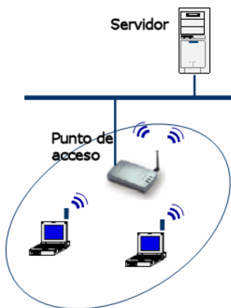
Figura 2.2: Diagrama de red básico de una Wireless LAN en infraestructura
