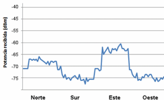
Figura 6.1: Muestras de potencia recibidas en una coordenada para distintas orientaciones.
