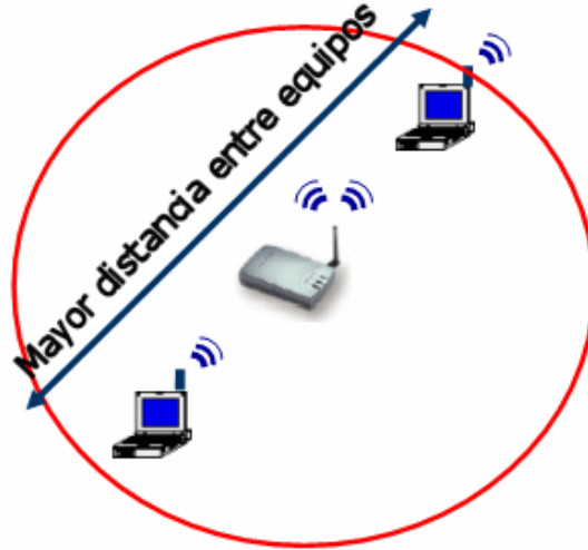
Figura 2.3: Punto de acceso en modo 'repetidor' para alcanzar mayor distancia.
