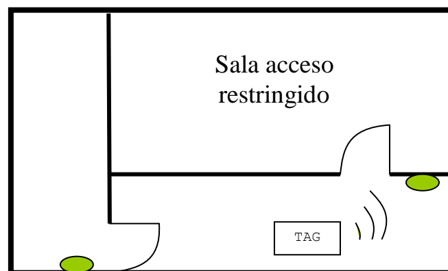
Figura 3.5: Tag que envía por radiofrecuencia la identificación del usuario para acceder a zonas determinadas.
