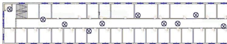
Figura 8.16: Distribución de puntos Wifi añadidos aleatoriamente para la simulación.
