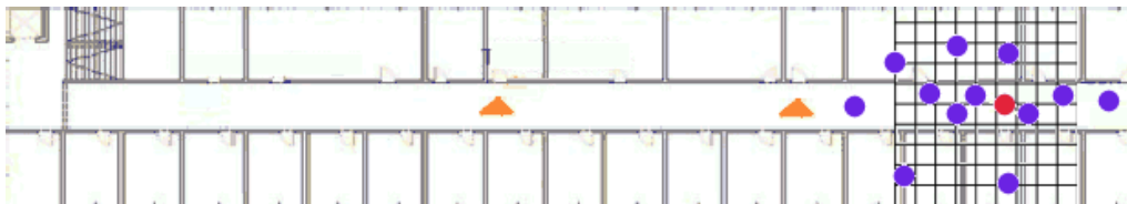
Figura 8.13: Resultados de la localización para la coordenada (55,5'5) usando el valor promedio de las potencias recibidas.
