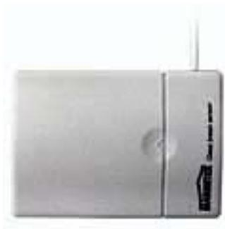
El Sensor de rotura de cristales consiste en un transmisor RF y un micrófono. El micrófono integrado permite detectar la frecuencia de vibración típica de rotura de un cristal. Los sensores se deben registrar o asociar al Maxicontrolador, con un máximo de 32 en total.
