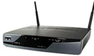
Con este MODEM router, nos comunicaremos con los dispositivos domóticos en la casa a través de Internet. Por ejemplo, si a través de la cámara IP vemos que hemos dejado un luz encendida, podemos mandar la orden de ‘apagar’, como nuestra cámara está conectada a dicho router, será este quien mande la señal al Maxicontrolador para que actúe en consecuencia.
