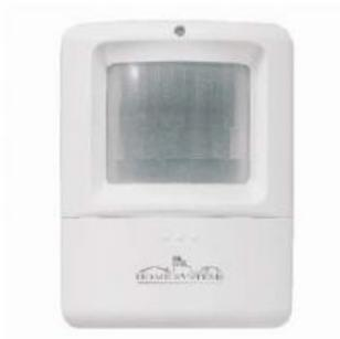
El detector de movimiento RF es un detector inalámbrico con tecnología PIR para detectar intrusos en interiores. Esta tecnología detecta cambios bruscos de temperatura. El detector dispone de un selector de sensibilidades (para evitar falsas detecciones de animales domésticos).
