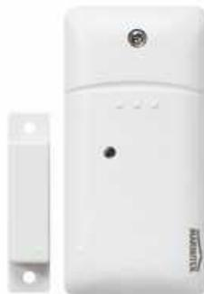
El sensor de apertura / transmisor universal consiste en un transmisor RF y un contacto magnético. El contacto magnético consta de un imán. Normalmente el imán cierra el contacto con el sensor.
