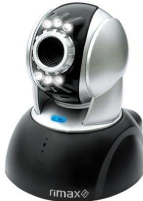
Cámara motorizada con un ángulo de 350° horizontal y 215° vertical, de ésta manera se podrán ver todos los puntos del lugar vigilado. Incorpora infrarrojos para mantener controlada el área vigilada tanto de día como de noche. Con el software incorporado, cuando la cámara detecte movimiento, grabará las imágenes en una tarjeta SD incorporada, o si se prefiere, le enviará dichas imágenes por e-mail o vía Internet.
