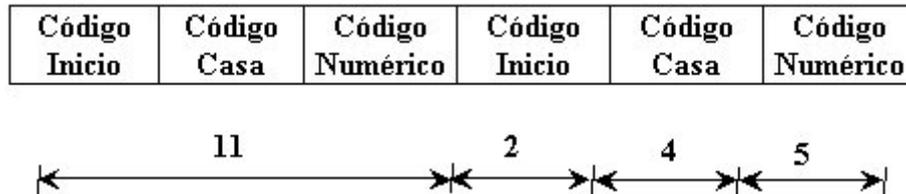
Para aumentar la fiabilidad del sistema, esta trama (Código de Inicio, Código de Casa y Código de Función o Numérico) se transmite siempre dos veces, separándolas por tres ciclos completos de corriente. Hay una excepción, en funciones de regulación de intensidad, se transmiten de forma continuada (por lo menos dos veces) sin separación entre tramas.
