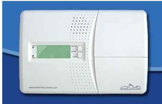
El Maxicontrolador LCD es una central domótica de control y seguridad con tecnología X10, fabricada por Home Systems. Utiliza la RF y la propia red eléctrica de la vivienda para comunicar los diferentes accesorios. Este sistema permite controlar telefónicamente luces y aparatos, detectar intrusos o fugas técnicas, avisar telefónicamente en caso de alarma y gestionar la temperatura de la vivienda de forma programada.
