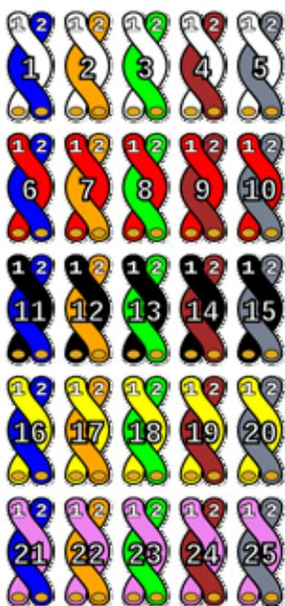
Esta figura nos muestra el código de colores empleado por los cables de 25 pares, para facilitar su conexión, a los terminales de las distintas regletas. Para diferenciar los primeros 25 pares de los segundos, los primeros 25 vienen rodeados de una cinta con los colores del par 1 (blanco, azul) y los 25 siguientes con los del par 2 (blanco, naranja).
