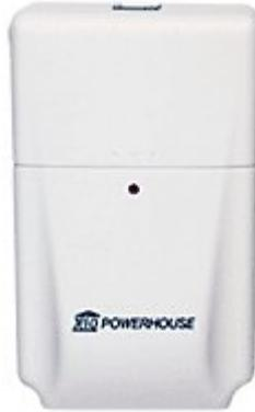
Permite compatibilizar equipos electrónicos con la tecnología X10, como por ejemplo centrales de seguridad, pantallas táctiles, cámaras IP, pasares residenciales y otros equipos del mercado.
