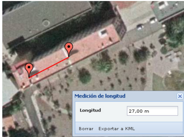
Figura 7.15. Alcance obtenido en el interior del Pabellón C sin antena externa
