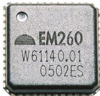
Figura 4.2. Procesador ZigBee EM260
