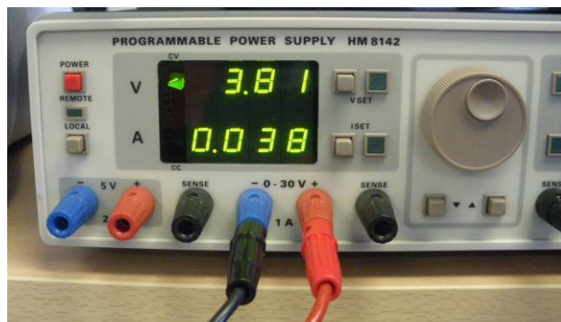
Figura 7.7. Consumo del nodo sensor inalámbrico en modo reposo
