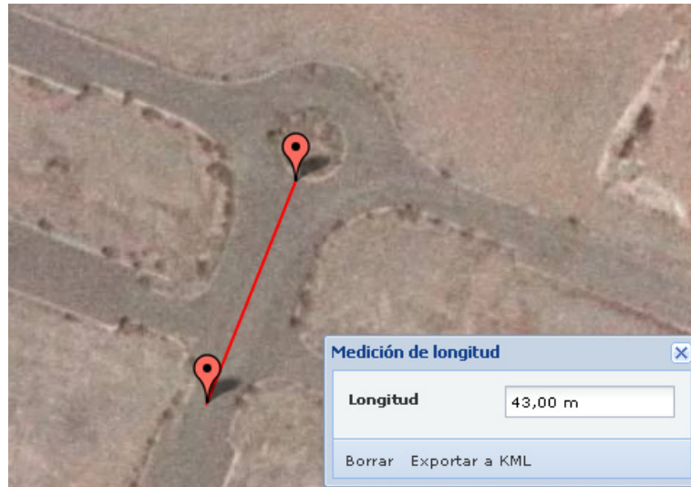
Figura 7.12. Alcance máximo en espacio abierto empleando antena externa
