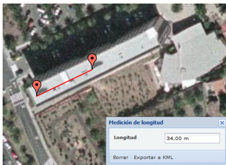
Figura 7.13. Alcance obtenido en el interior del Pabellón A sin antena externa
