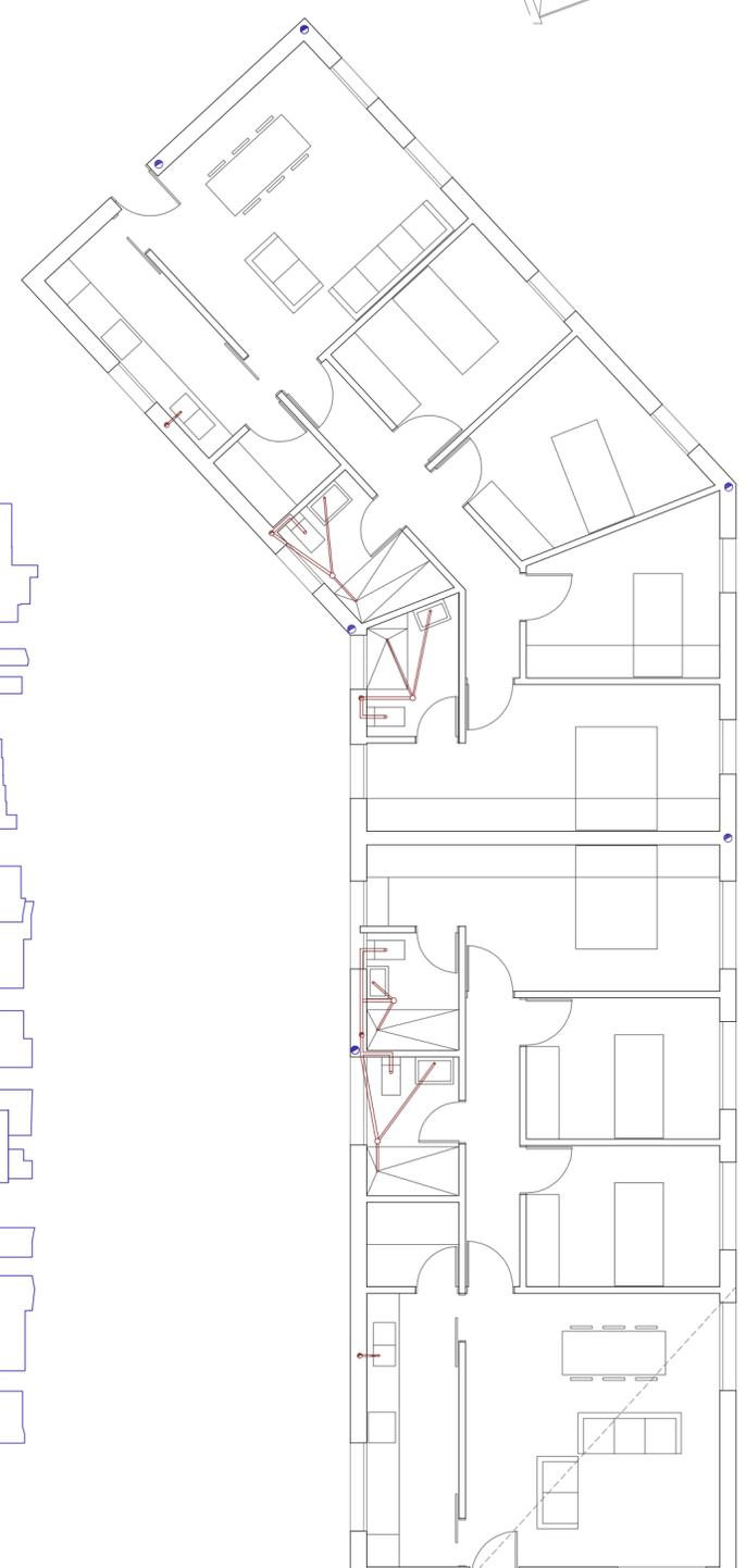
PLANTA BAJA: conexión evacuación de los pluviales del patio trasero con los bajantes del edificio Escala 1:400
