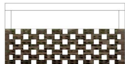
muros palomeros (cerramiento pesado): elemento de protección de la vivienda frente a la vía.
