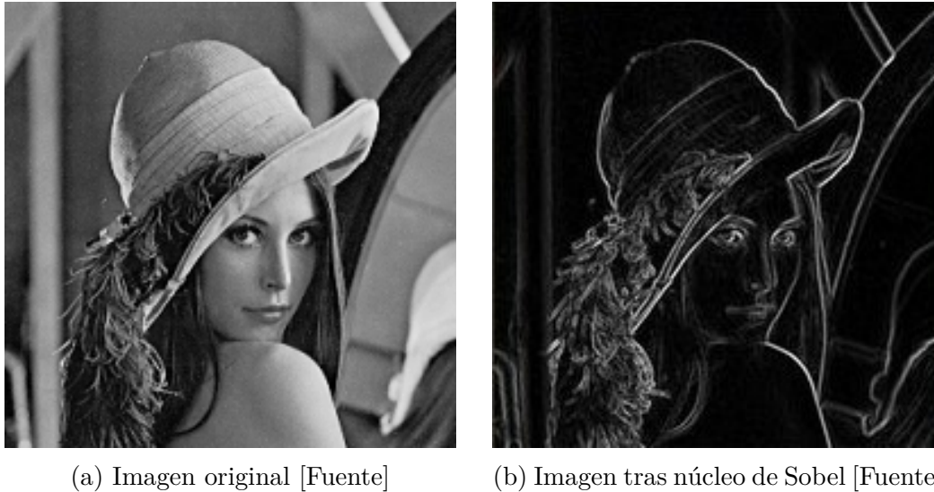
Figura 6.8: Transformación de imagen filtrada por un núcleo de Sobel
