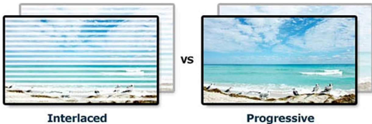
Figura 6.3: Diferencia entre fotogramas con exploración entrelazada y progresiva [Fuente]
