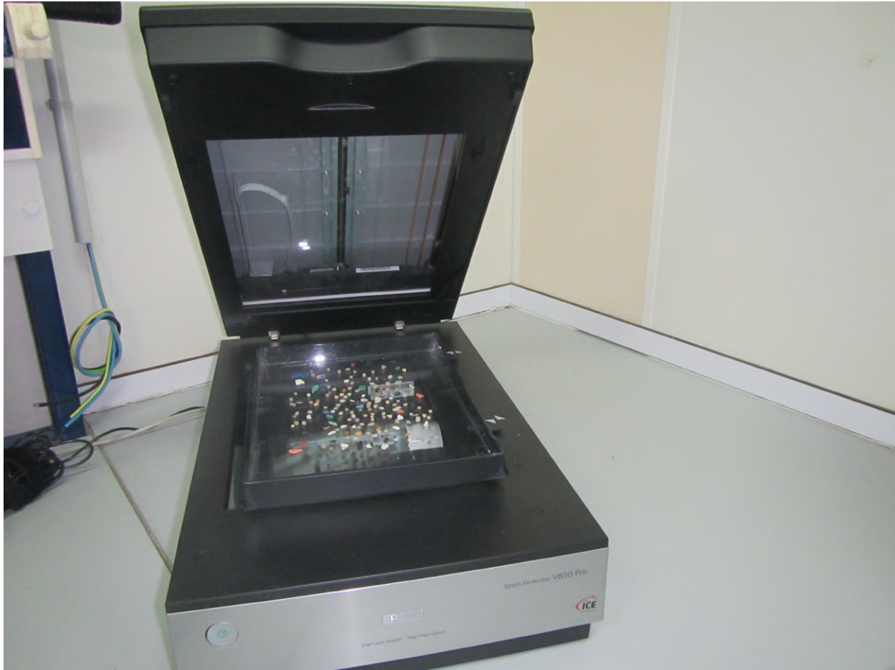
Figura 1.7: Escáner que se usa para obtener las imágenes en alta resolución de los microplásticos
