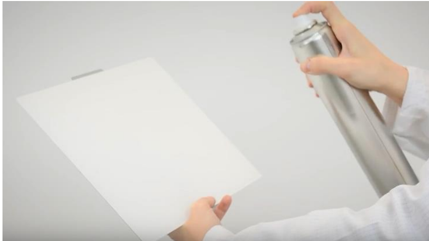
Figura 45.- Rociando laca en la cama de impresión.
