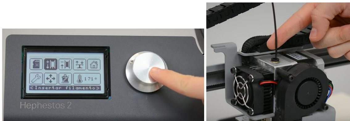
Figura 44.- Inserción de filamento.
