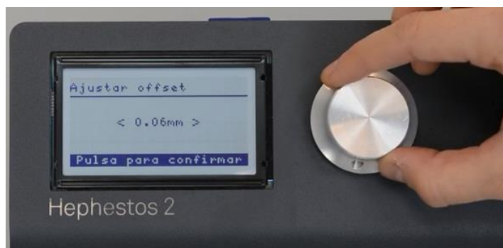
Figura 42.- Ajuste del offset manualmente.
