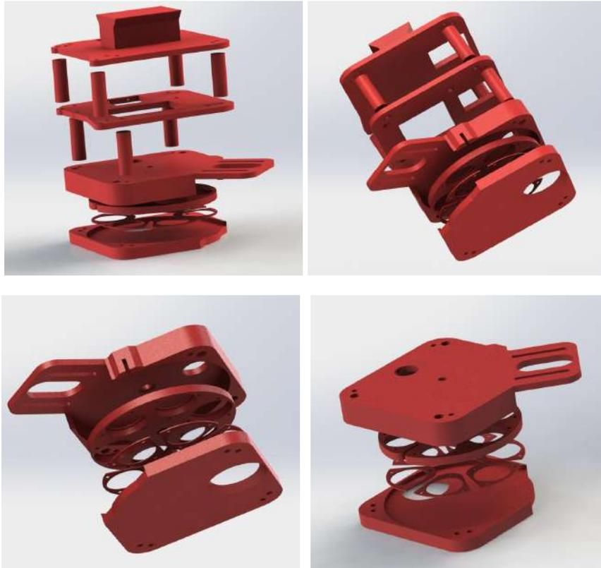
**Figura 3.2:** Modelo 3D de la estructura modular de la cámara
