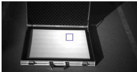
**Figura 3.12:** Imagen guía en el proceso de calibración obtenida mediante el filtro de 670nm
