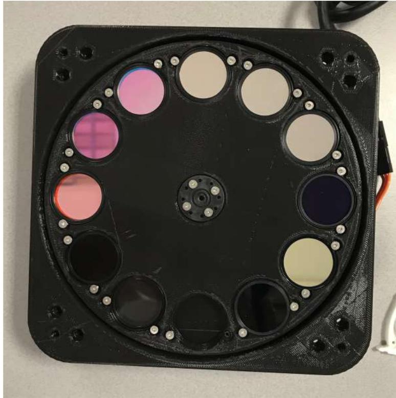
**Figura 4.14:** Diseño alternativo planteado en este proyecto que emplea una rueda mayor capaz de capturar 12 bandas.
