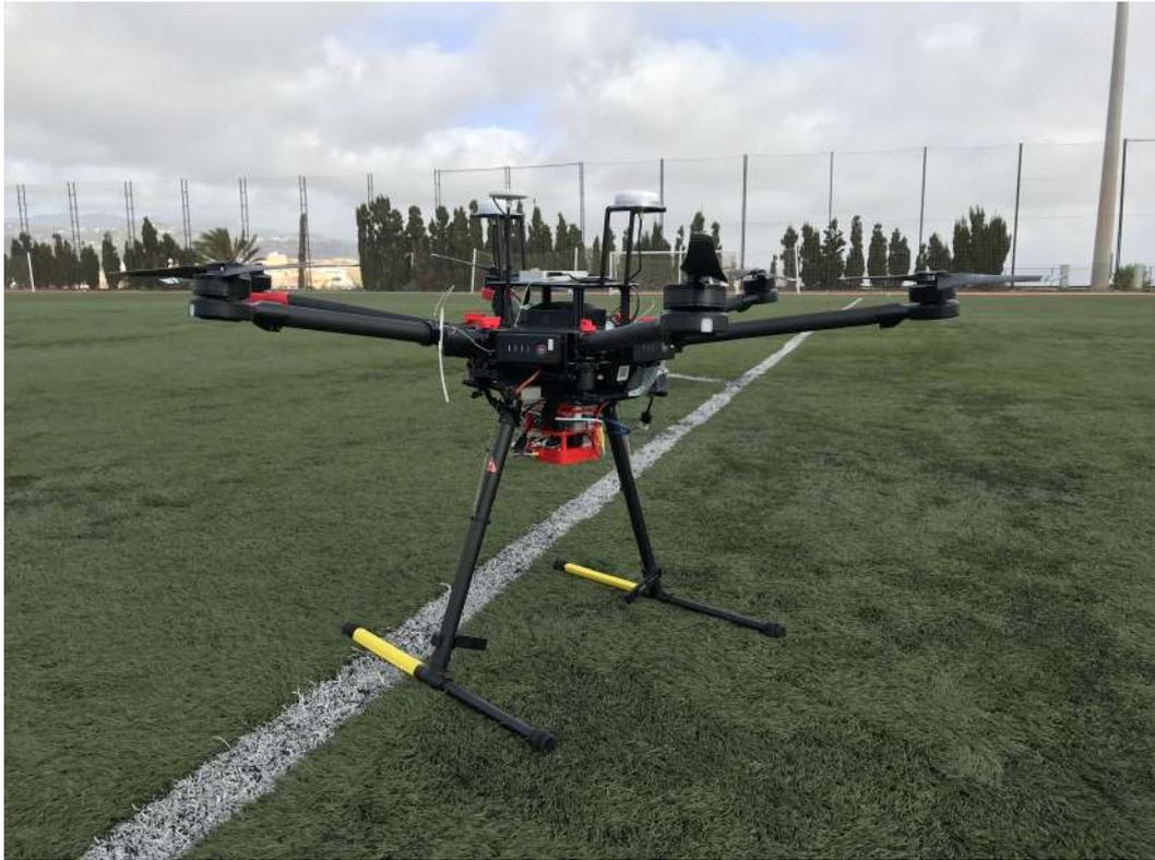
**Figura 4.11:** La cámara espectral desarrollada acoplada al dron M600.
