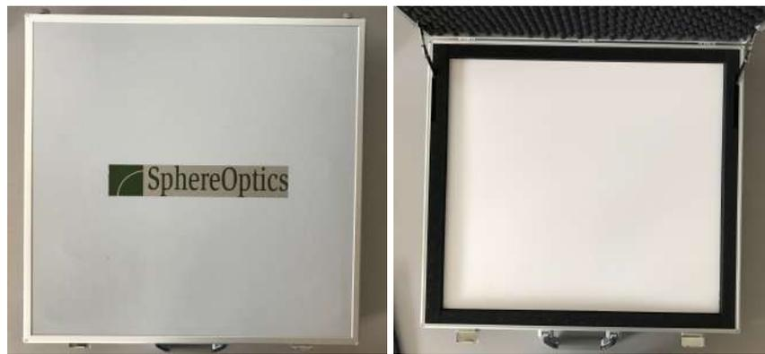
**Figura 3.6:** Referencia de blanco empleada para la calibración
