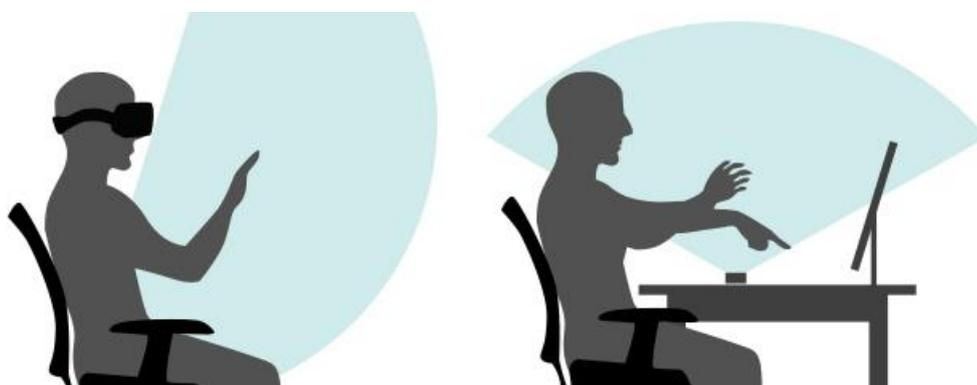
Figura 2.2.: Posicionamiento del Leap Motion [17]
