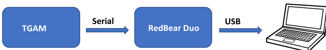
Figura 4.1 - Elementos de la conexión
