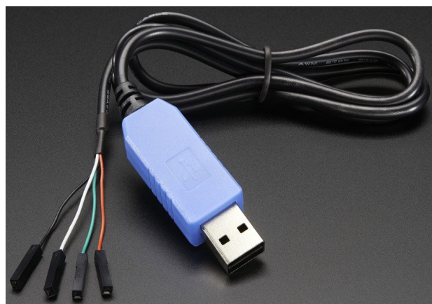
Figura 3.13 - Cable USB TTL de Adafruit [13]
