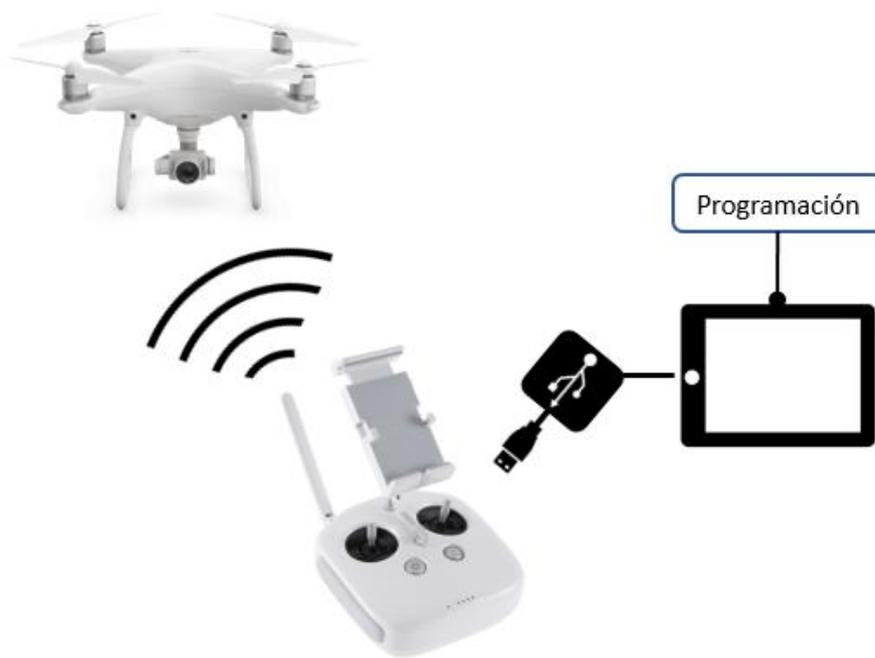
Figura 7. Esquema de conexiones del Phantom 4
