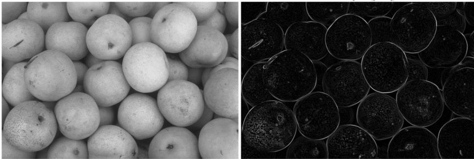
Figura 5: A la izquierda, imagen original en escala de grises. A la derecha, su gradiente (en magnitud), mediante operador Sobel [8].
