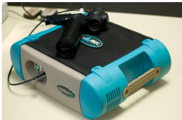
Figura 4.4. Radiómetro empleado en la campaña de campo.
