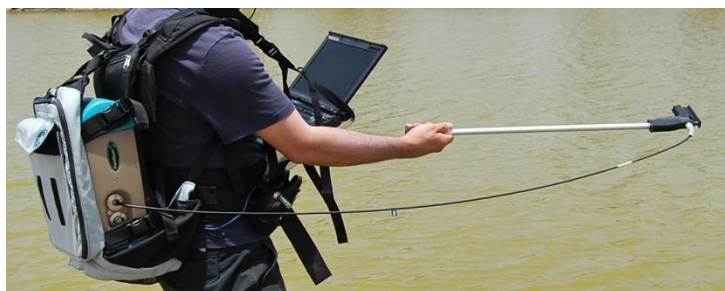
Figura 4.5. Empleo del radiómetro para medir la respuesta espectral de la Charca de Maspalomas.
