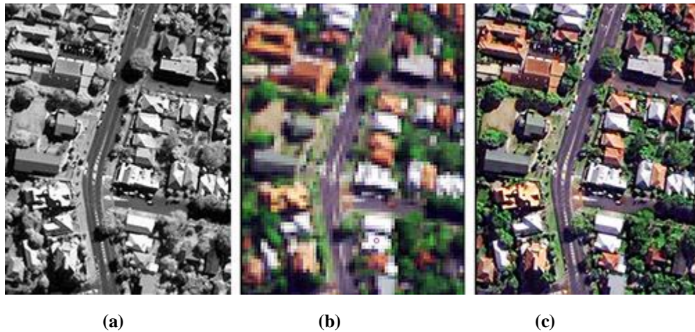
Figura 2.8. (a) Imagen pancromática, (b) imagen multispectral y (c) imagen fusionada [16].
