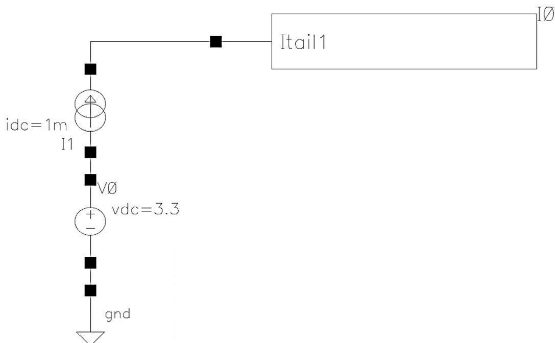
**Figura 3.20. Setup de simulación del espejo de corriente.**
