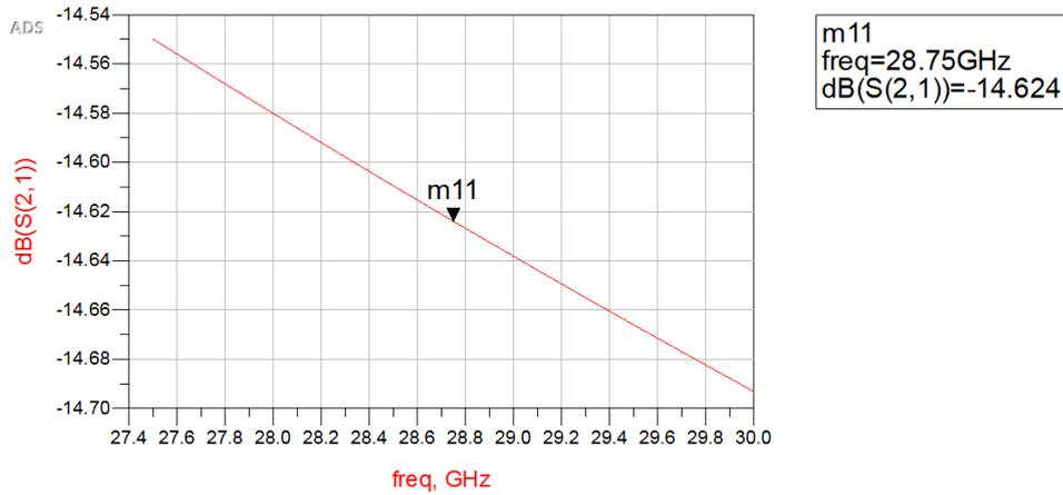
Figura 2.26. Pérdidas por inserción del filtro de paso total en cuadratura ideal con  $R_L$ .
