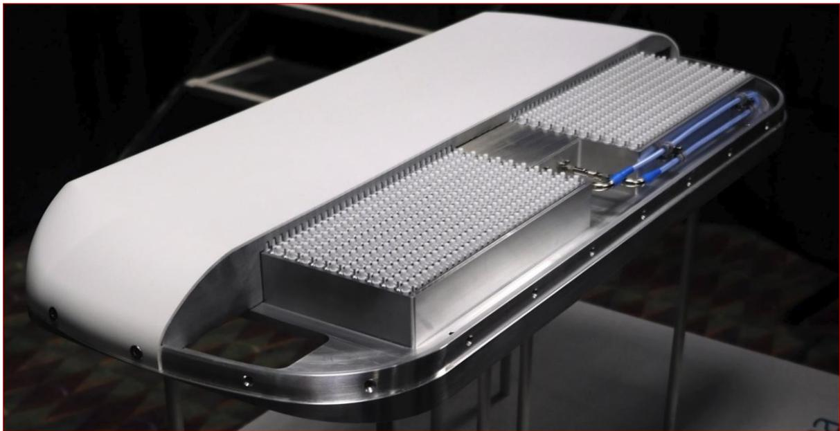
Figura 1.1. Antena de tipo *phased array*.
