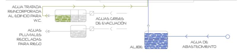
Las aguas grises separadas en el proceso de evacuación, se tratarán en base al esquema señalado a continuación y posteriormente se reincorporarán al edificio tratándolas de manera que puedan aprovecharse para sistemas del wc, riego...
