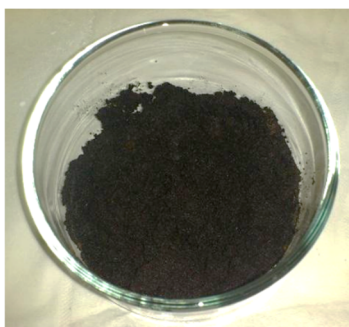
Fig. 2. 10- Aspecto de la fracción B tras los procesos de acondicionamiento, impregnación con H_3PO_4 y doble secado.
