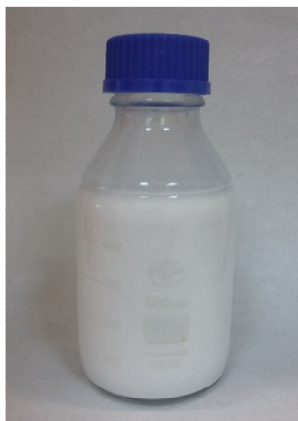
Fig. 3. 12- Suspensión etanólica de Aeroxide® TiO 2 P25 (Evonik Industries), dosis de P25: 32 g·L -1 .
