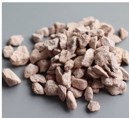
Fig. 1.13- Zeolita de origen sintético. Fuente: [96].
