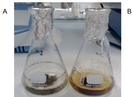
Fig. 2. 19- Aspecto final de las muestras con valor de pH inicial 2 (A) y 12 (B) para PalCan.
