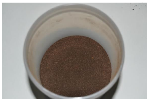
Fig. 2. 8- Aspecto de la fracción B, con tamaño de partícula comprendido entre 106 y 250 \mu\text{m} .
