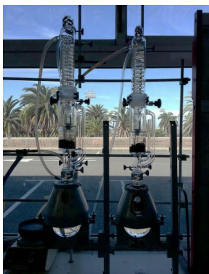
Fig. 2. 11- Lavado de los carbonizados mediante extracción Soxhlet, con agua Milli-Q®, en el Laboratorio de Tecnología Química General. Al fondo, ejemplares de palmera canaria.
