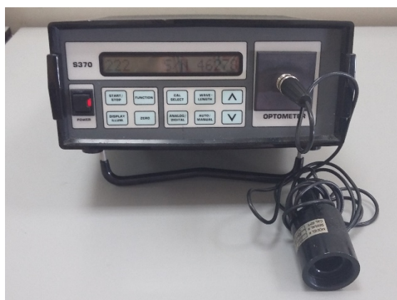
Fig. 3. 17- Optómetro S370 con detector #222 (200 – 400 nm) (Graseby Optonics).
