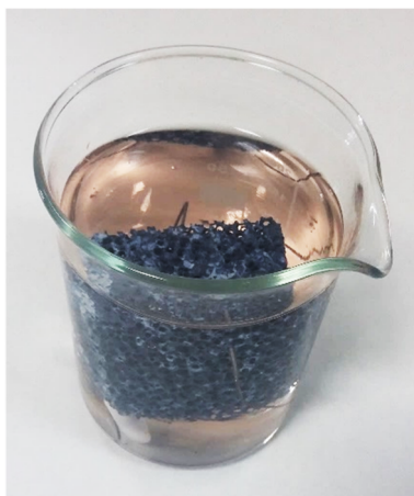
Fig. 3. 25- Coloración rosada observada en las “pruebas de calidad” durante la degradación de fenol con una unidad VLD-P25.
