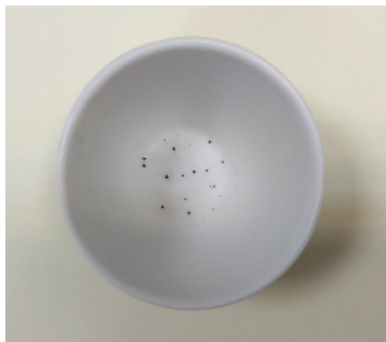
Fig. 2. 20- Cenizas de Darco® KB-G (Norit) tras tratamiento térmico a 650 °C durante 3 h en atmósfera autogenerada.
