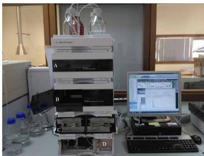
Fig. 2. 24- Cromatógrafo HPLC Infinity 1260 (Agilent Technologies): A) módulo de distribución de fase móvil, B) automuestreador, C) módulo de columna y D) detector.
