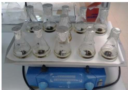
Fig. 2. 18- Ensayo para la determinación del pH_{ZPC} de PalCan mediante el método drift .
