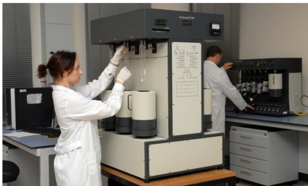
Fig. 2. 15- Miembros de la Unidad de Análisis Térmico y Sólidos Porosos de la UA. Delante: sistema Autosorb-6, detrás: sistema Autosorb Degasser, ambos de la firma Quantachrome Instruments. Fuente: [69].
