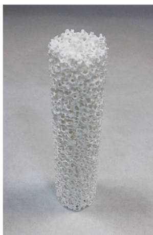
Fig. 3. 21- Filtro cerámico VZA empleado como soporte de TiO 2 en los ensayos a escala semi-piloto.
