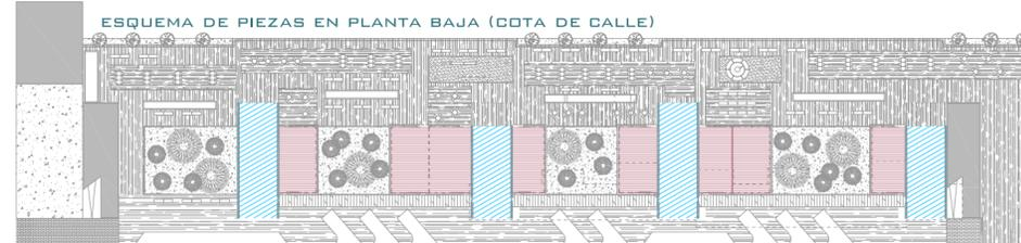
LAS VIGAS VIEREENDEL CONFORMAN LAS PIEZAS QUE ALBERGAN LOS USOS Y QUEDAN SUSPENDIDAS EN EL AIRE. SE DISPONEN EN SENTIDO TRANSVERSAL A LOS ENTRAMADOS DE CERCHAS. SE DAN EN PLANTA BAJA, PLANTA 1º Y PLANTA 2º.
