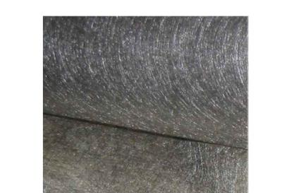
**GEOTEXTIL DE POLIÉSTER**
