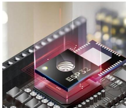
*Figura 27. ESP32 montado sobre placa [25].*
