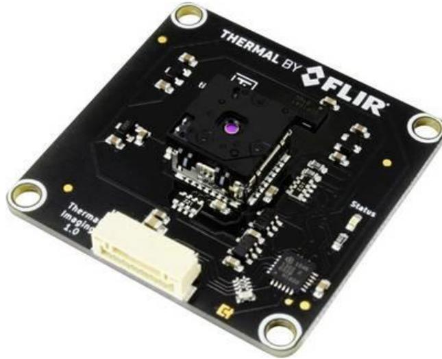
*Figura 80. Cámara TinkerForge 278.*
