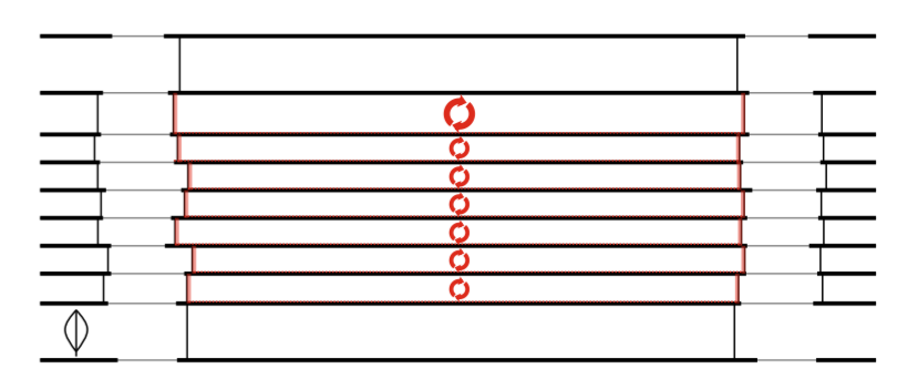
invierno noche. sistema de calefacción por acumulación térmica: pcm + suelo radiante + heat mirror.
