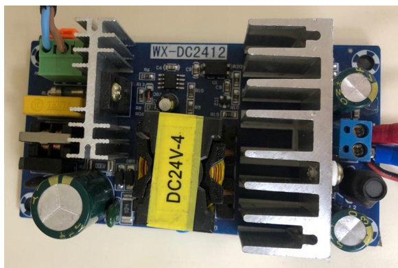
Figura 111. Fuente conmutada. Fuente: elaboración propia
