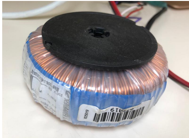
Figura 108. Transformador 50 Hz. Fuente: elaboración propia
