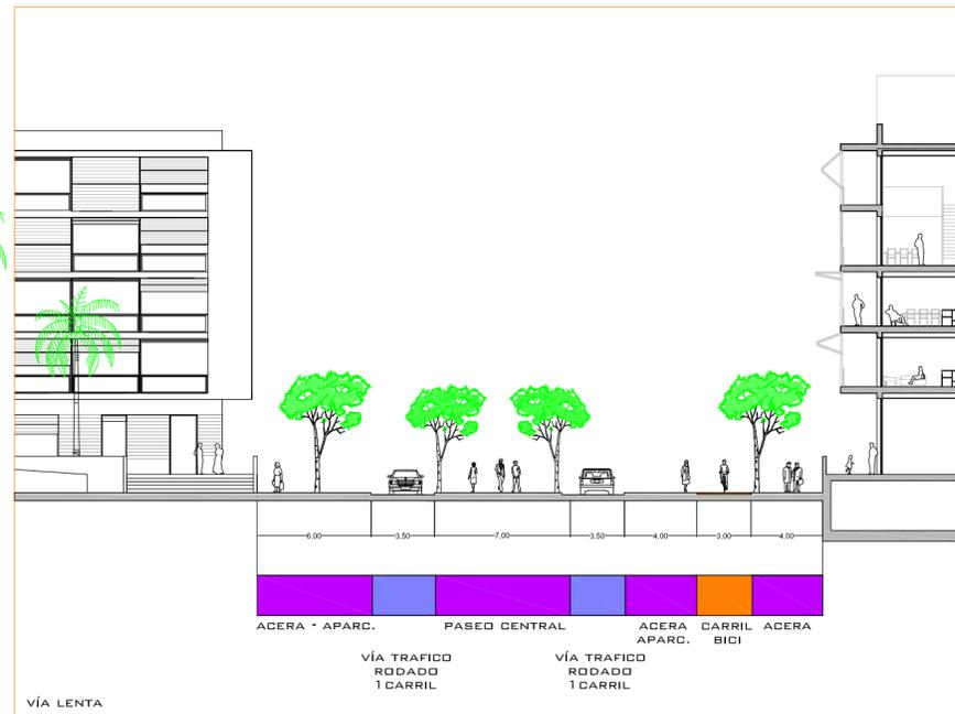
SECCIÓN B-B' AMPLIACIÓN C1 ESCALA: 1/300
