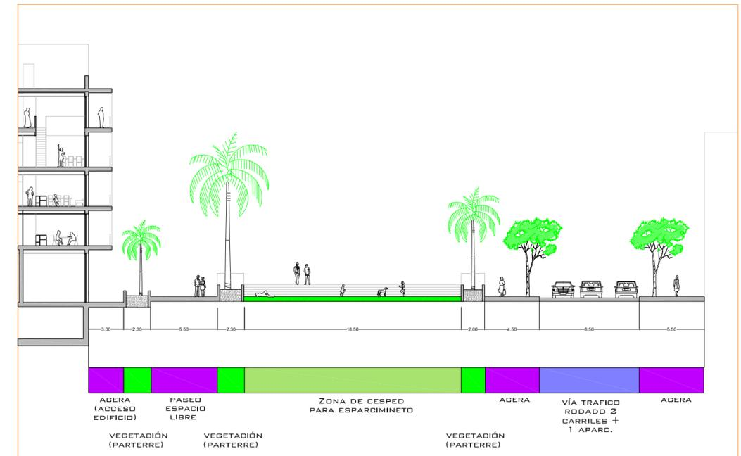
SECCIÓN B-B' AMPLIACIÓN D1 ESCALA: 1/300
