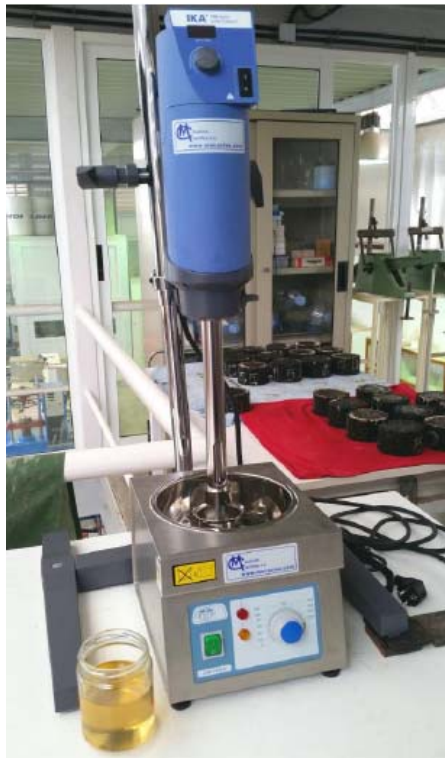
Figura 5.2 Unidad mezcladora para preparar el betún mejorado con caucho y el aditivo de las mezclas semicalientes. En el lateral del equipo, el aditivo químico empleado.
