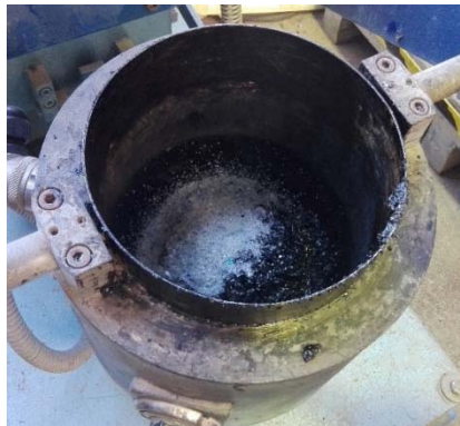
Figura 6.2 Mezclado del árido cubierto con ligante y las partículas de PET
