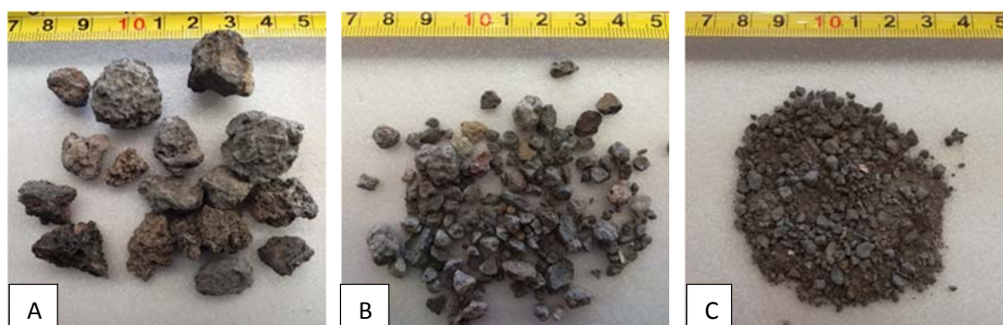
Figura 4.1 Árido BOPV procedente de la cantera de La Esfinge (Autoridad Portuaria de Las Palmas, GC): a) fracción 10/20 mm, b) fracción 4/10 mm y c) fracción 0/4 mm.
