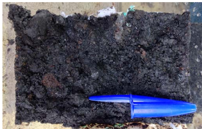
Figura 4.2 Muestra de una probeta cilíndrica fabricada con un 6.0% de BC35/50
