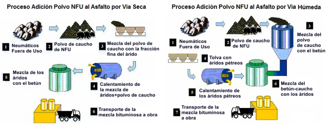
Figura 2.1 Ejemplo de adición de un residuo polimérico a las mezclas bituminosas por la vía seca y por la vía húmeda. (Bisso, 2010)
