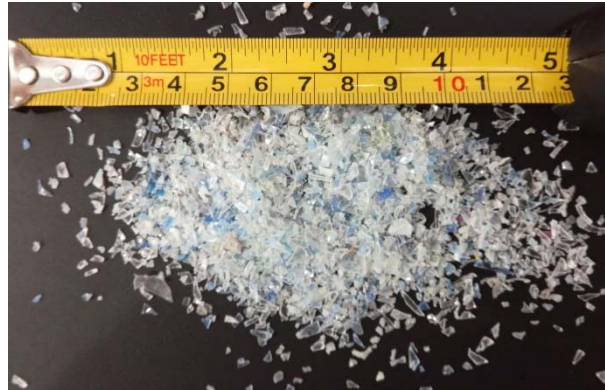
Figura 6.1 Partículas de PET \# \leq 4 mm empleadas para la fabricación de las MBC.
