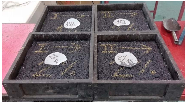
Figura 6.13 Probetas tipo placa de mezcla 50/70 con un 1% y un 2% de PET s/peso del árido compactadas mediante rodillo.
