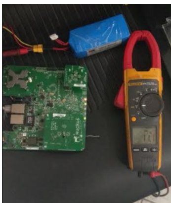
Figura 4.2: Prueba de funcionamiento del PA con batería de 3 celdas.
