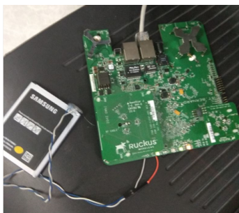
Figura 4.1: Prueba de funcionamiento del PA con batería de 3,85 V.
