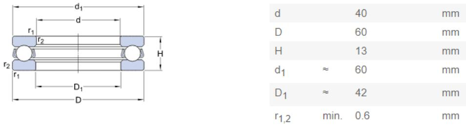
Figura 3.3. Dimensiones rodamiento de bolas.
