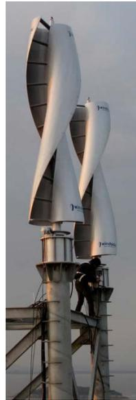
**Figura 15. Aerogenerador tipo Savonius**
