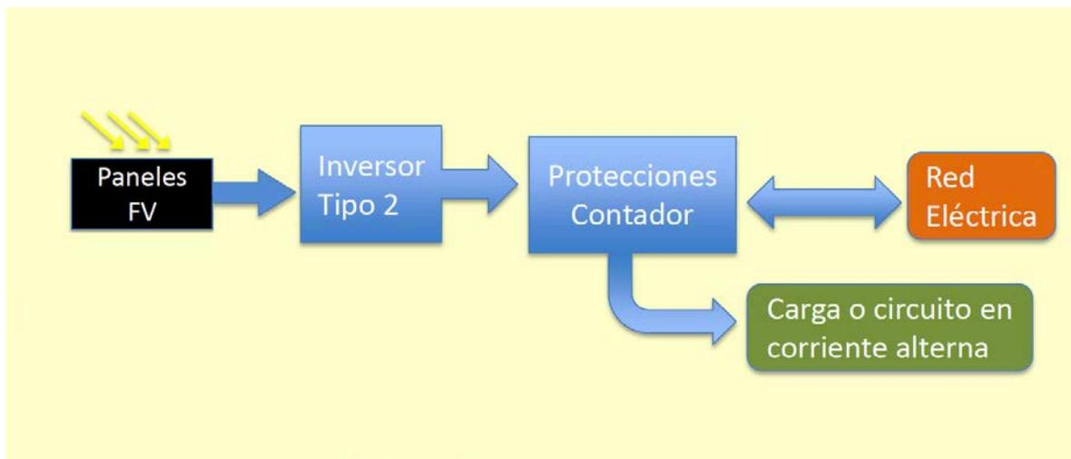
*Figura 102. Sistema de generación interconectado con EERR [26]*
