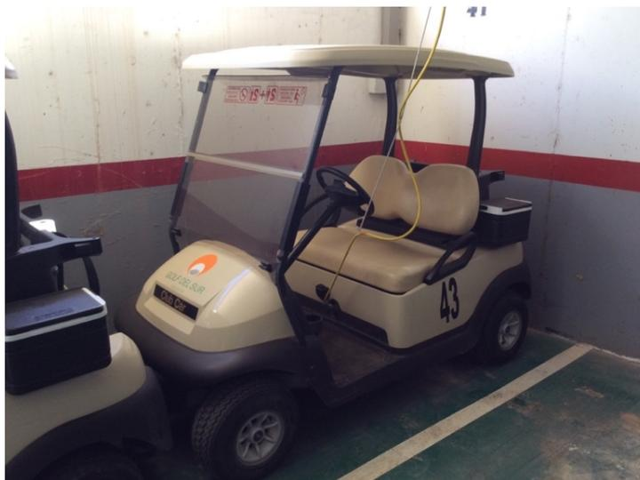
**Figura 57. BE conectado a la red eléctrica**
