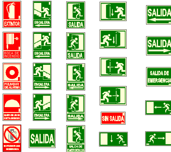
Figura 3.7: Señalización de emergencia con símbolos normalizados
