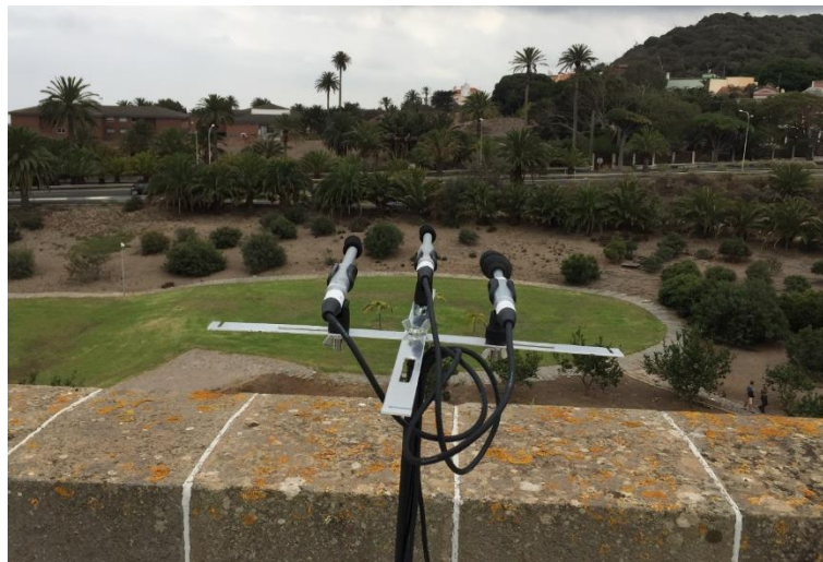
Figura 3. 1.- Agrupación de micrófonos (array) con soporte para los micrófonos mediante dos láminas de aluminio.
