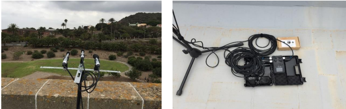
Figura 4. 1.– Array de tres micrófonos conectado a la grabadora para recoger el sonido ambiente.
