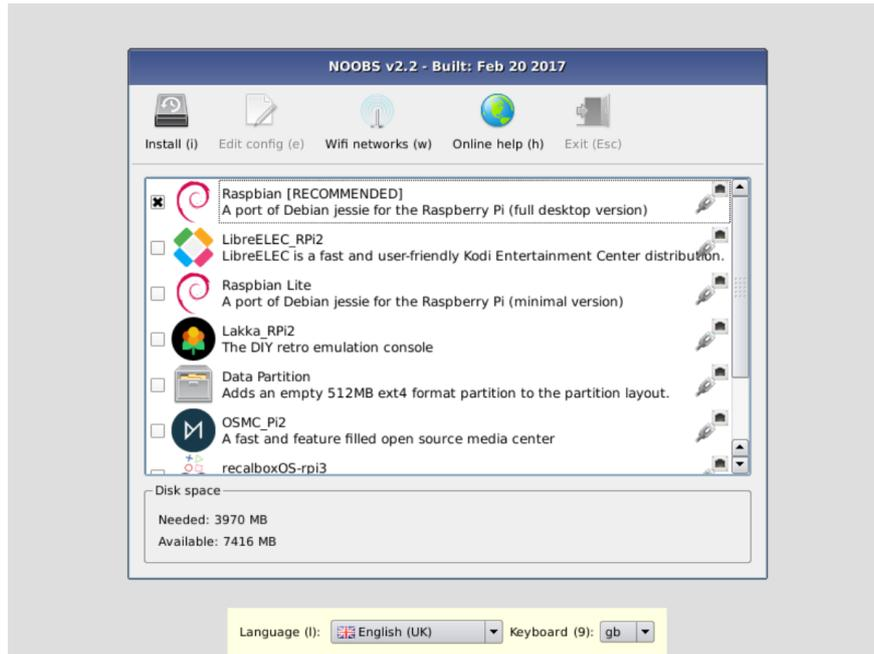
Figura A.1: Selección de Raspbian para ser instalado en la Raspberry Pi 3
