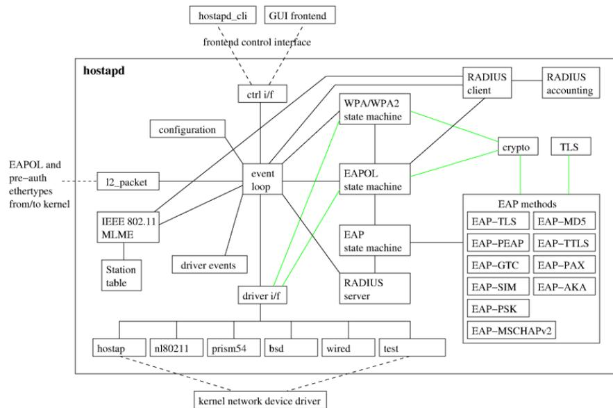
Figura 3.2: Esquema general del funcionamiento de Hostapd
