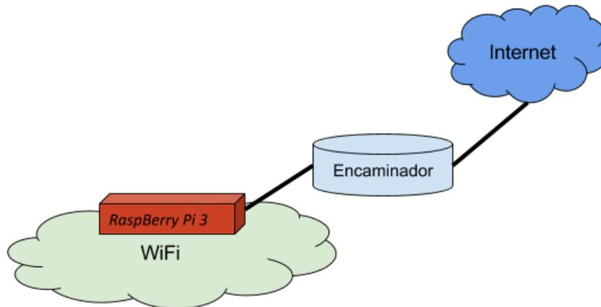
Figura 2.3: Esquema general de la infraestructura para proporcionar acceso a Internet mediante una aplicación de sensado móvil colaborativo
