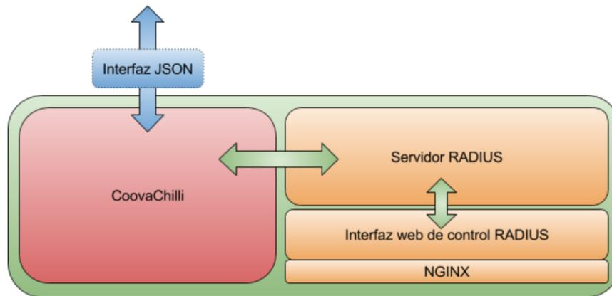
Figura 4.4: Diagrama de submódulos del módulo Control de Acceso
