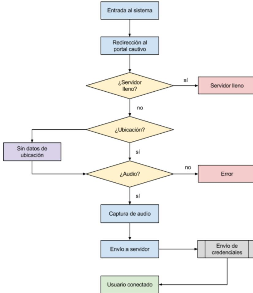
Figura 4.3: Diagrama de la funcionalidad de la conexión a Internet a través del portal cautivo modificado
