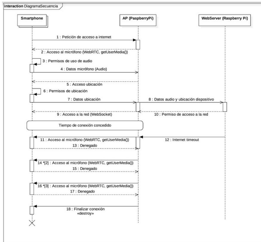
Figura 5.9: Diagrama de secuencia de los componentes del módulo de Usuario
