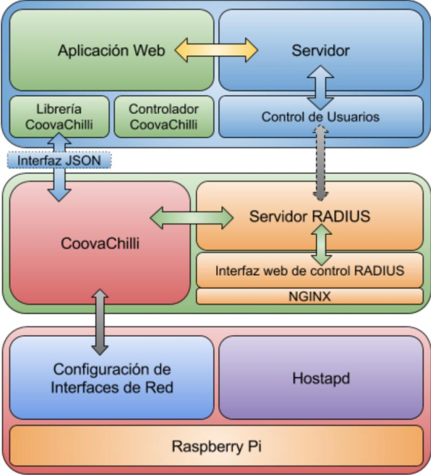
Figura 4.6: Esquema completo de los módulos funcionales del sistema
