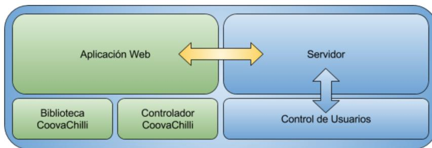
Figura 4.2: Diagrama de submódulos del módulo Usuarios
