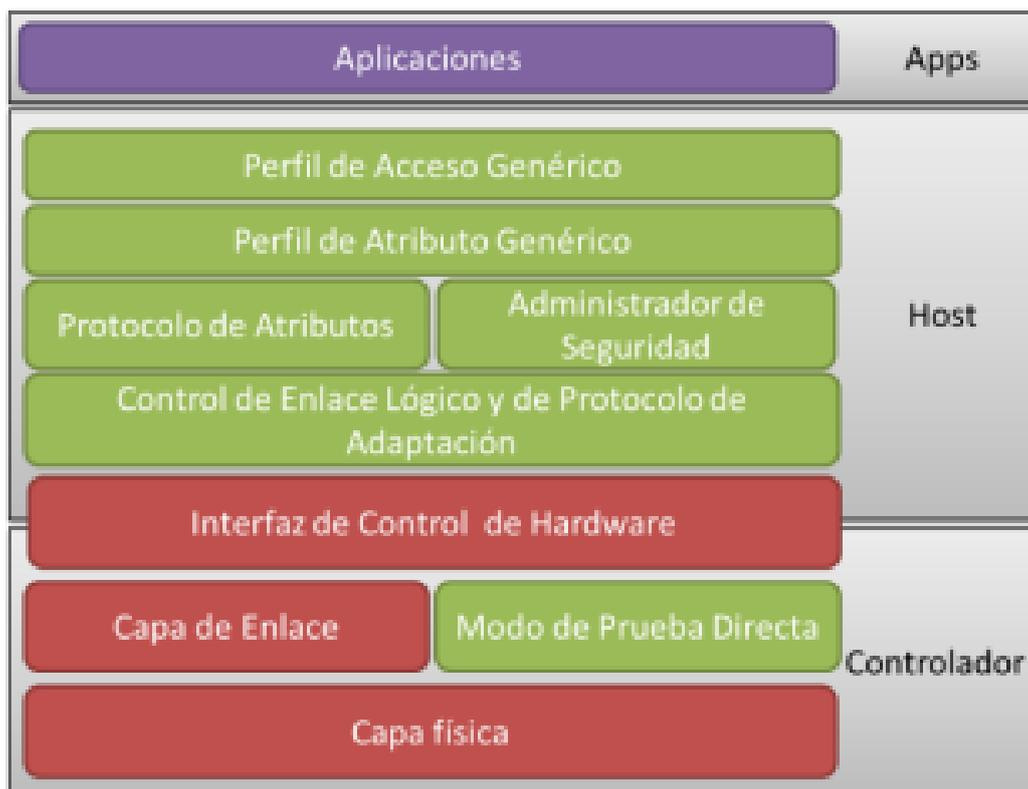
Figura 39. Pila de protocolos de BLE.
