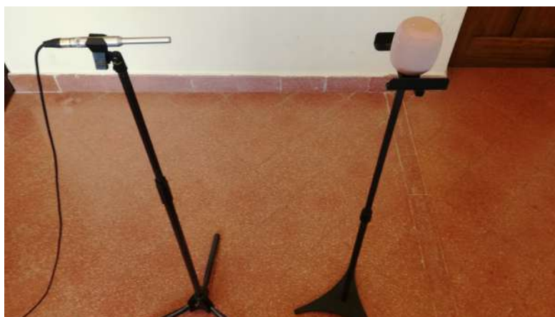
Figura 5.1: Montaje del altavoz en estudio para las medidas de caracterización
