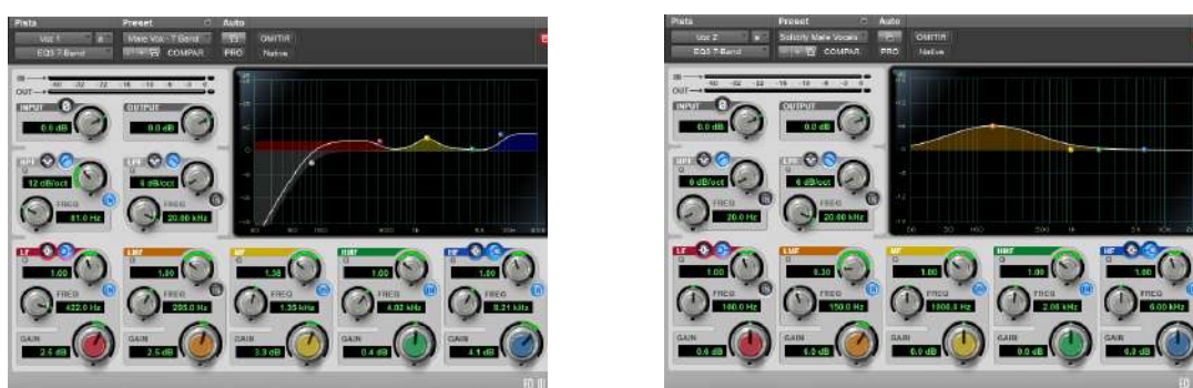
Figura 4.12: Parámetros de ecualización de refuerzo de voz y pronunciación de sílabas
