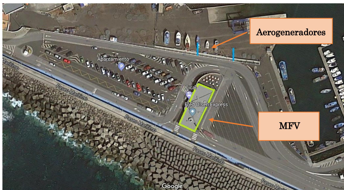
Figura 59. Propuesta final de emplazamiento del generador híbrido. Fuente: Google Maps
