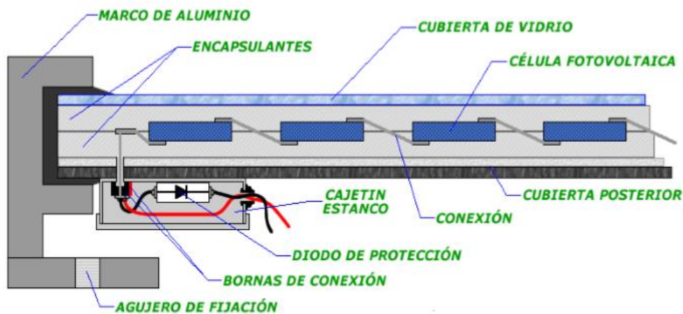
Figura 45. Elementos de un MFV. Fuente: UJA
