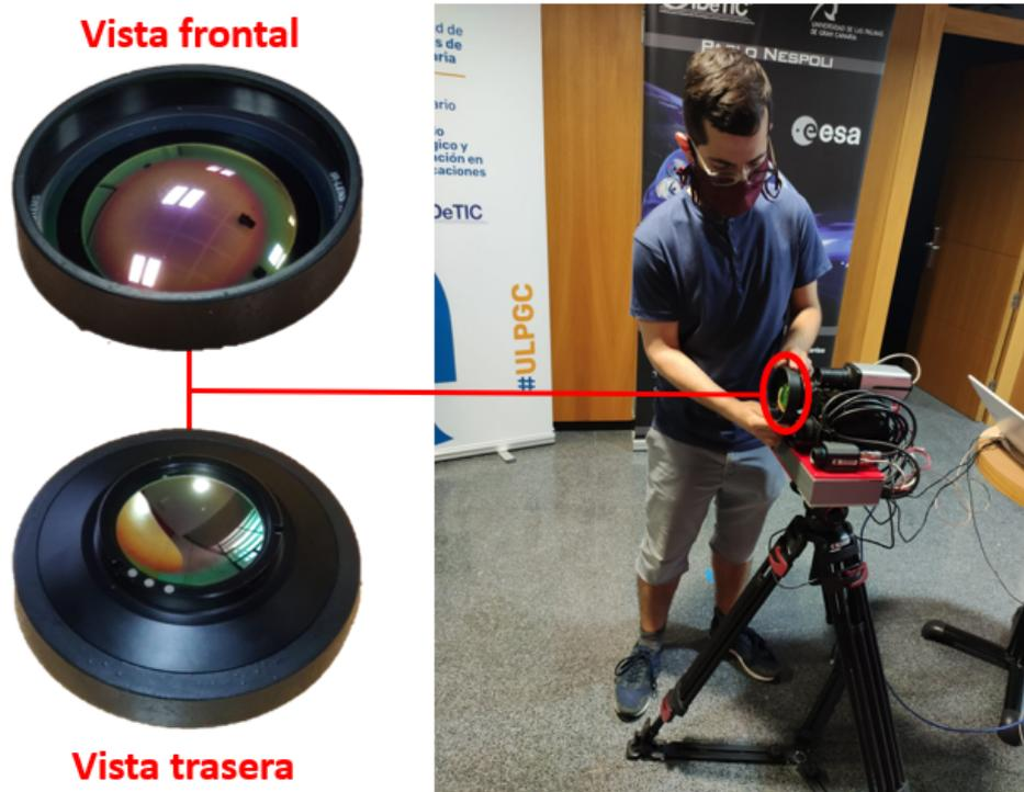
Figura 5.14: Superposición de ópticas para la captación de datos
