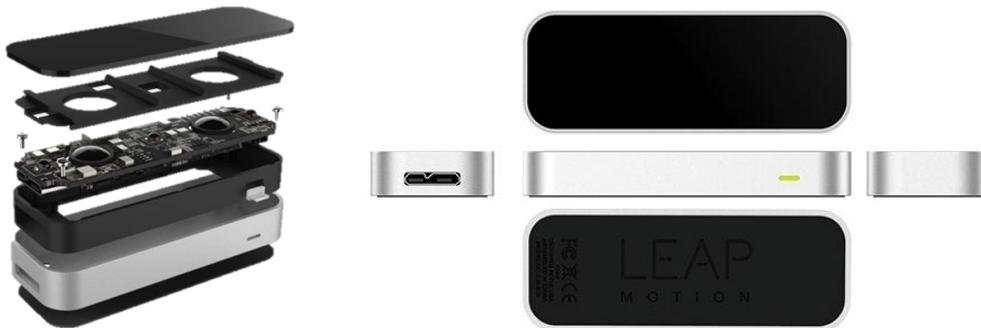
Figura 3.1. Componentes del sensor y vistas de este.
