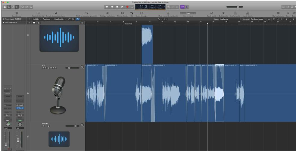
**Ilustración 53: Ejemplo regulaciones y recortes manuales en una toma de voz**
