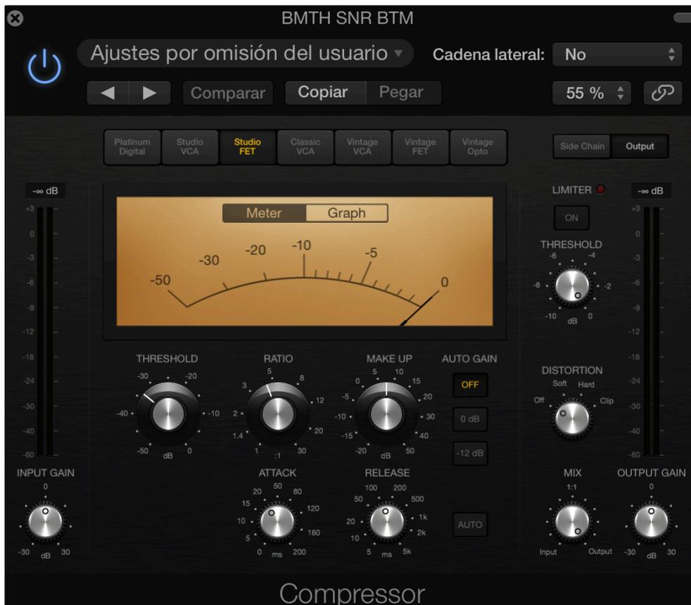
**Ilustración 17: Compresión aplicada al micrófono inferior de la caja**
