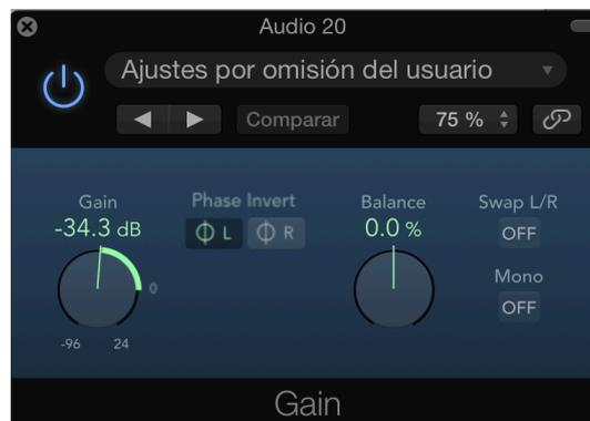
**Ilustración 49: Inversión de fase aplicada la señal paralela al sub-bajo.**
