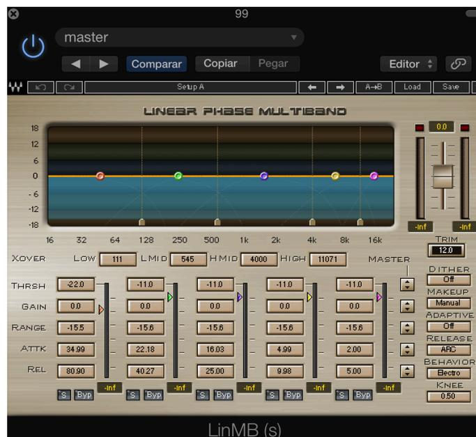
Ilustración 85: Compresor mutibanda para mantener un balance espectral.
