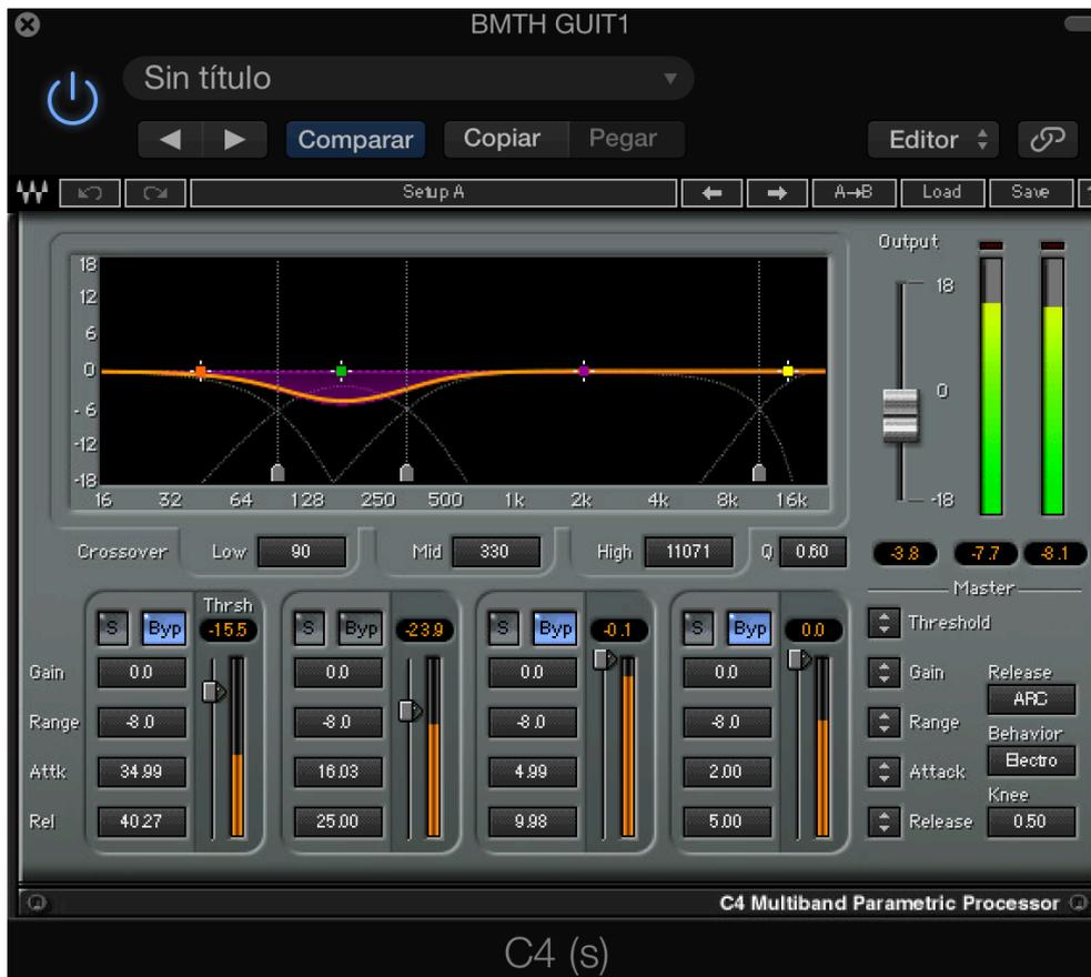
**Ilustración 34: Compresor multibanda aplicado a la guitarra.**
