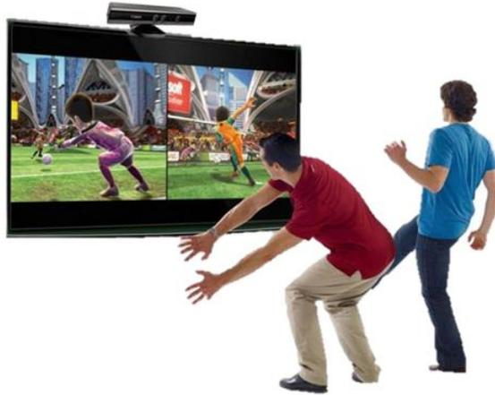
*Figura 131.-Captura del movimiento sin marcadores con la Microsoft Kinect*
