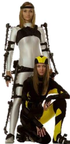
*Figura 127.- Sistemas de captura del movimiento electromecánicos*
