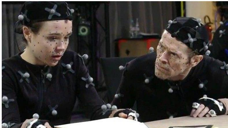
*Figura 130.- Sistemas ópticos con marcadores empleado en el videojuego Beyond Two Souls*
