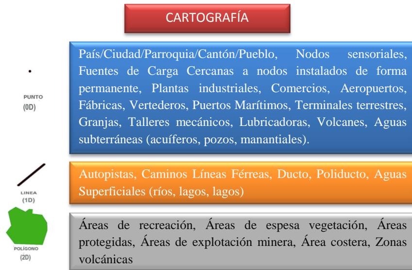
Figura 33: Capas vectoriales de la cartografía utilizada por la aplicación SIGMA.
