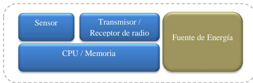
Figura 4: Componentes de un nodo de una red sensorial.
