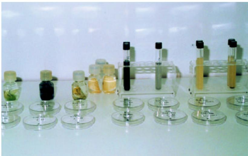
**Foto 1:** Aislamiento en medio de cultivo de Starkey de bacterias sulfatoredutoras. Se observan los precipitados negros debido a la producción de Sulfuro de Hierro.
