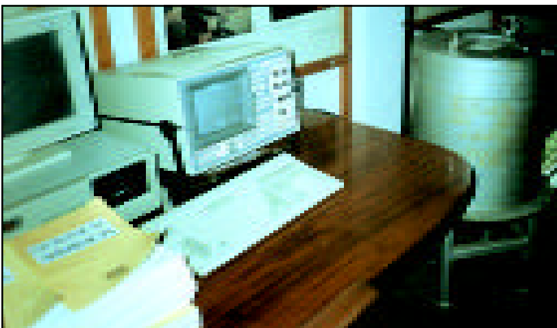
(Lam. II a) Equipo de espectroscopia de radiación gamma utilizado en la determinación del contenido en uranio, torio y potasio, de las muestras y sus sedimentos
