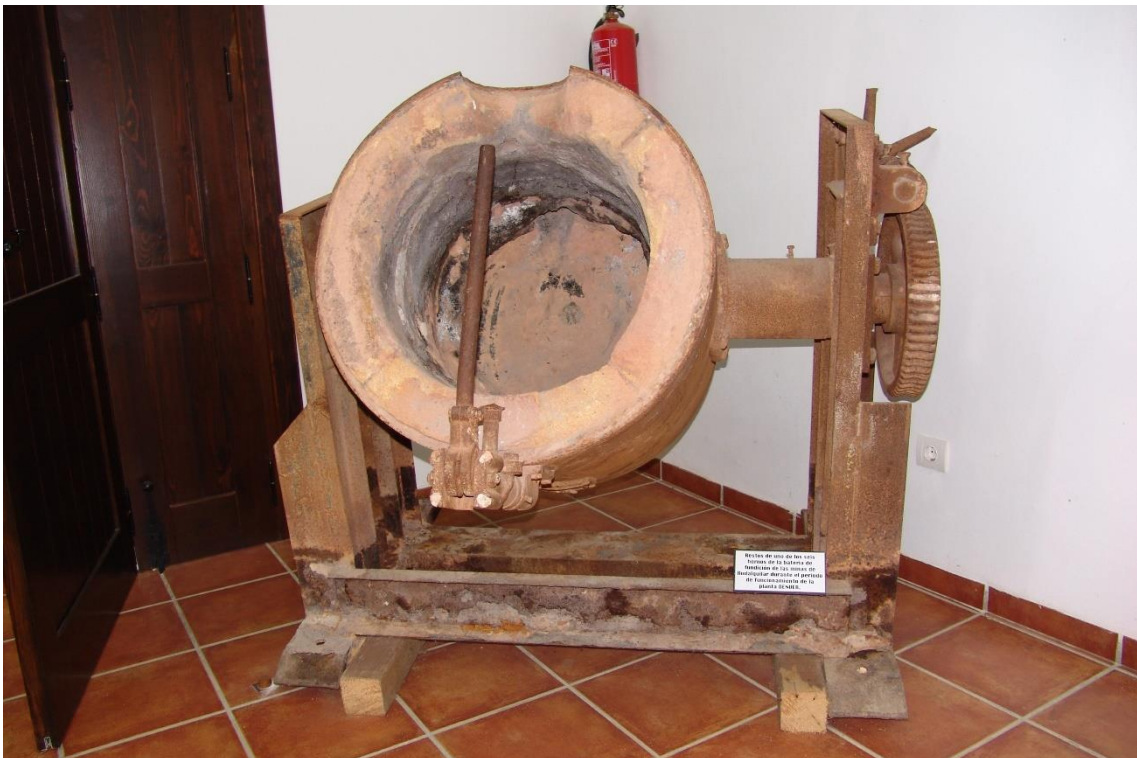
Fotografía 17.7: uno de los seis hornos de la batería de fundición de oro, para la posterior obtención de lingotes, conservado en la Casa de los Volcanes de Rodalquilar (Almería). Captura del 9 de marzo de 2010.
