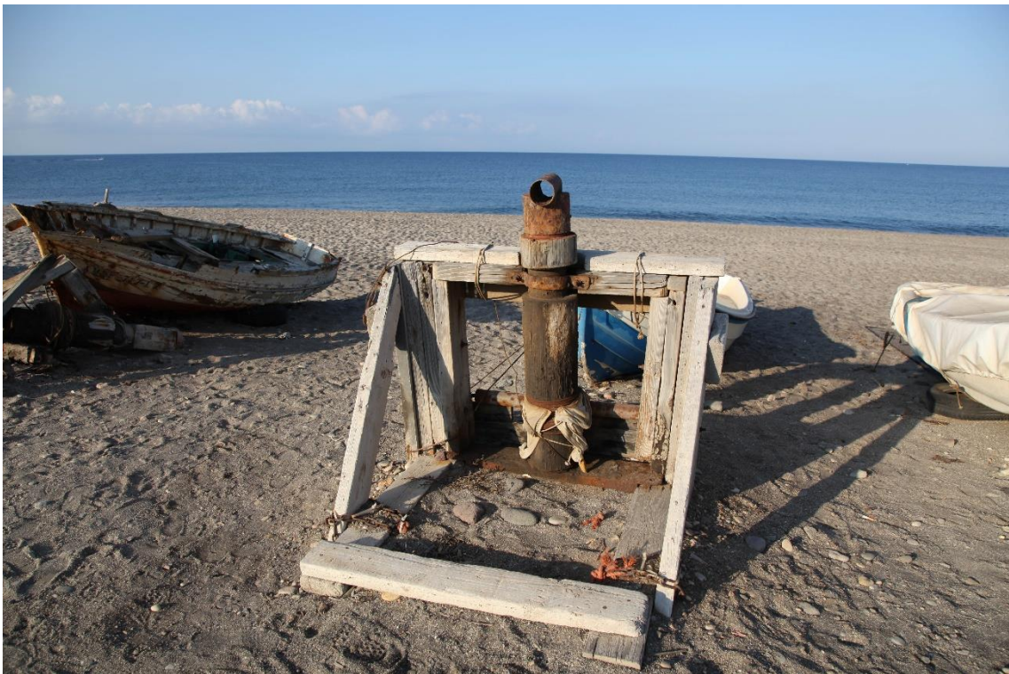
Fotografía 12.192: torno para la varada de barquitas pesqueras de los salineros. Playa de Las Salinas del Cabo de Gata (frente al poblado salinero). Captura del 25 de agosto de 2019.
