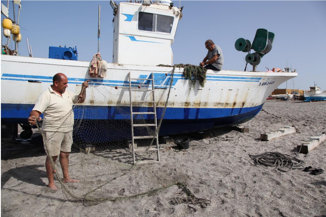
Fotografía 12.207: red de trasmallo junto al barco de pesca de don Jesús Román Alonso. En la proa del barco, se observa el borondo (argolla), que permite enganchar al cable de tiro de un torno eléctrico. A la derecha, se encuentran unos parales para la varada de la embarcación. San Miguel de Cabo de Gata (Almería). Captura del 2 de agosto de 2019.
