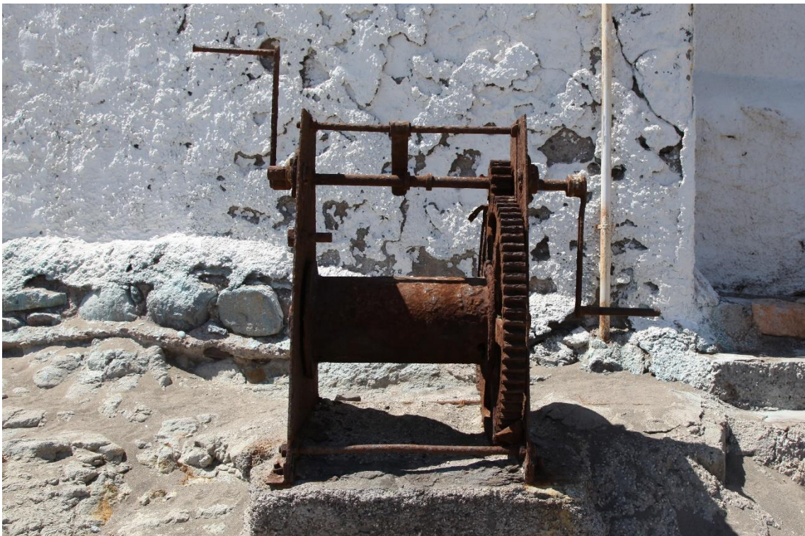
Fotografía 12.202: vista frontal del anterior torno, para la varada de las barquitas empleadas en la pesca artesanal, en las proximidades del muelle de levante (prácticamente en desuso), dentro del entorno de La Isleta del Moro. Captura del 16 de abril de 2019.
