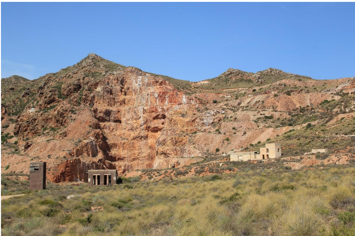
Fotografía 3.16: detalle de un sector de canteras en el Cerro de El Cinto, para extraer roca aurífera. Se observan los escalonamientos propios de una explotación a cielo abierto. Captura del 28 de agosto de 2011.
